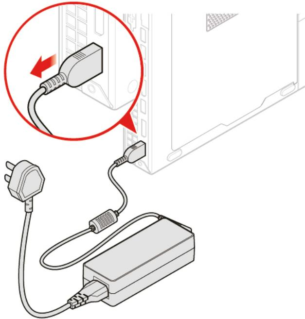
Abbildung 16. Netzteil entfernen
