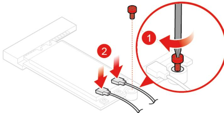
Abbildung 70. Wi-Fi-Antennen anschließen
