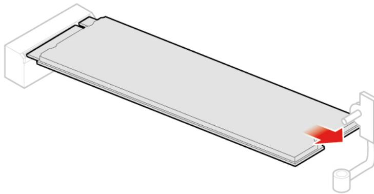
Abbildung 91. M.2-Solid-State-Laufwerk entfernen
