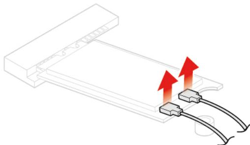
Abbildung 67. Wi-Fi-Antennen abziehen
