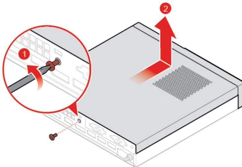
Abbildung 31. Computerabdeckung entfernen
