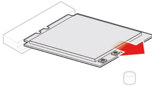
Abbildung 62. Wi-Fi-Karte entfernen
