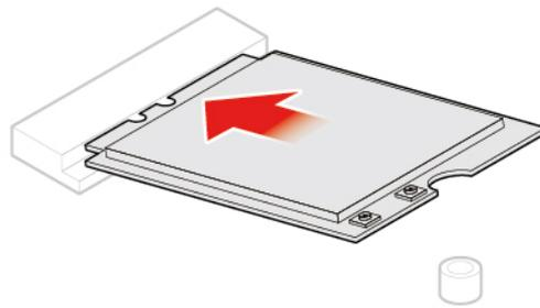
Abbildung 63. Wi-Fi-Karte installieren
