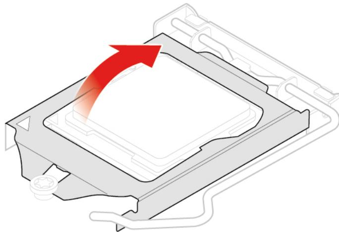
Abbildung 55. Mikroprozessorstecksockel nach oben drehen
