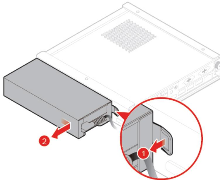
Abbildung 28. Netzteilhalterung entfernen
