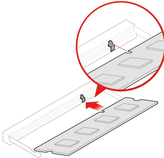
Abbildung 88. Speichermodul installieren
