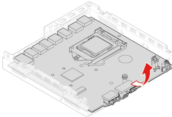
Abbildung 95. Systemplatine entfernen
