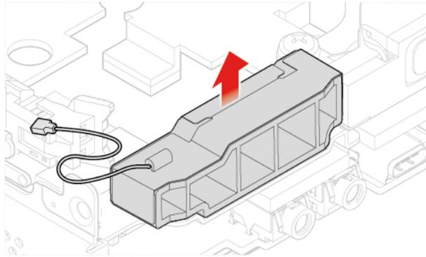
Abbildung 73. Vordere Wi-Fi-Antenne entfernen
