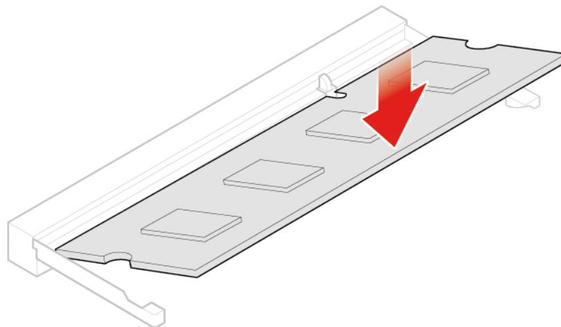
Abbildung 89. Speichermodulhalterung schließen
