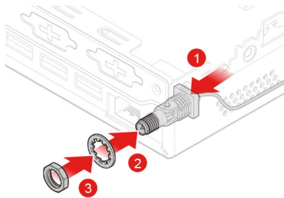
Abbildung 79. Hinteres Wi-Fi-Antennenkabel anschließen
