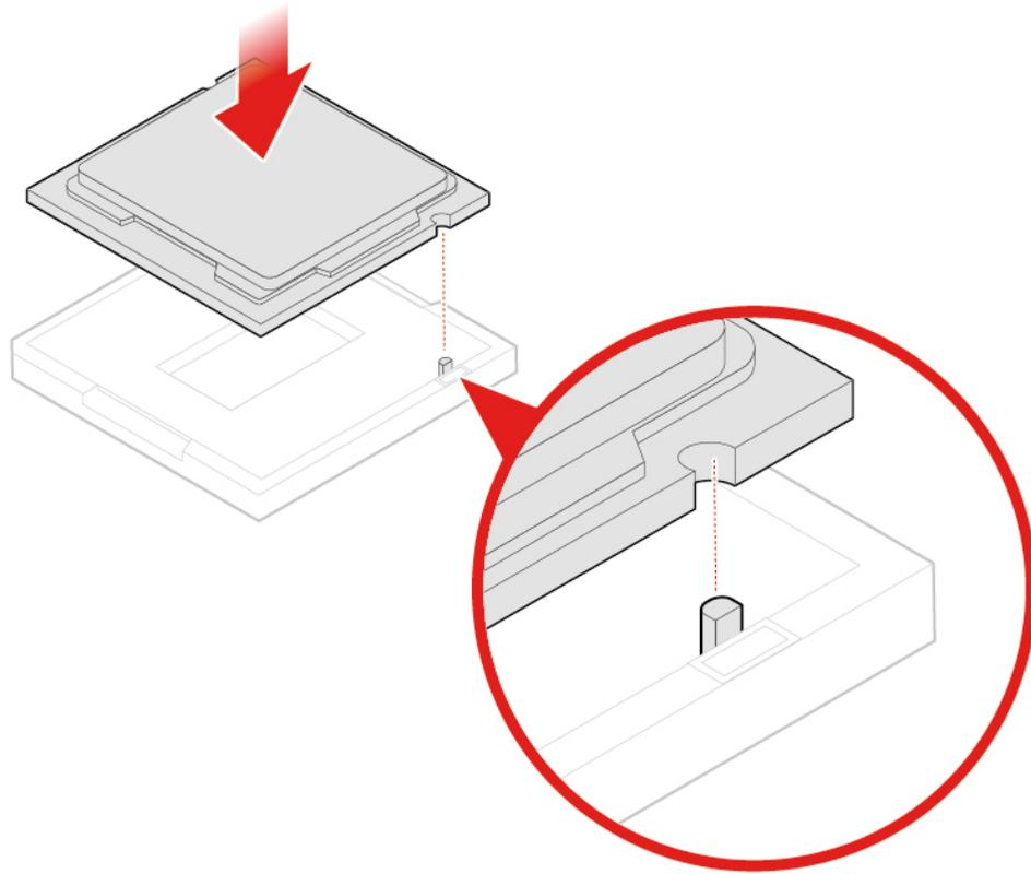
Abbildung 57. Mikroprozessor installieren
