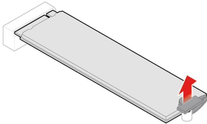
Abbildung 90. Die Klammer des M.2 Solid-State-Laufwerks entsperren
