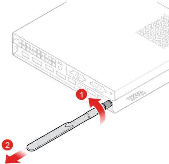
Abbildung 76. Hintere Wi-Fi-Antenne entfernen
