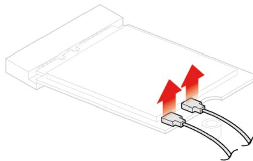
Abbildung 61. Wi-Fi-Antennen abziehen
