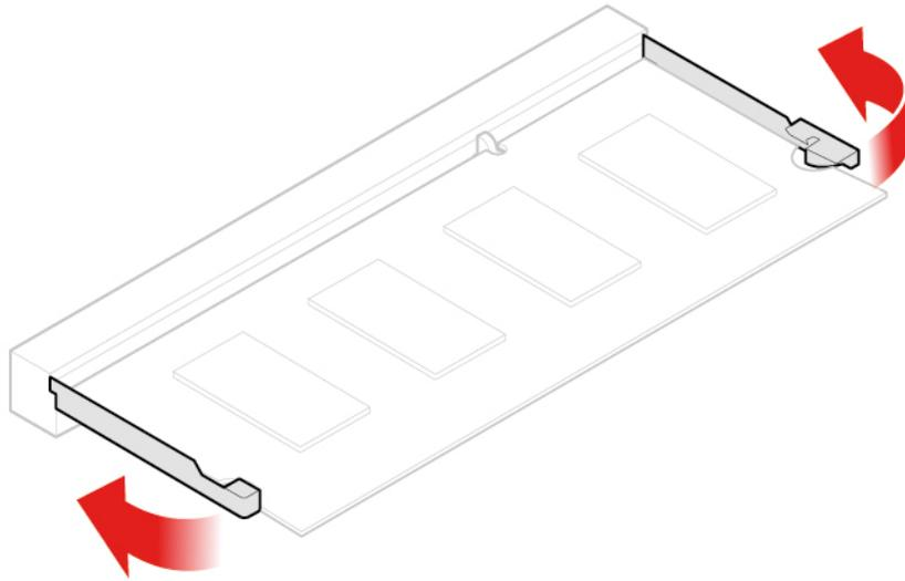
Abbildung 86. Speichermodulhalterung öffnen
