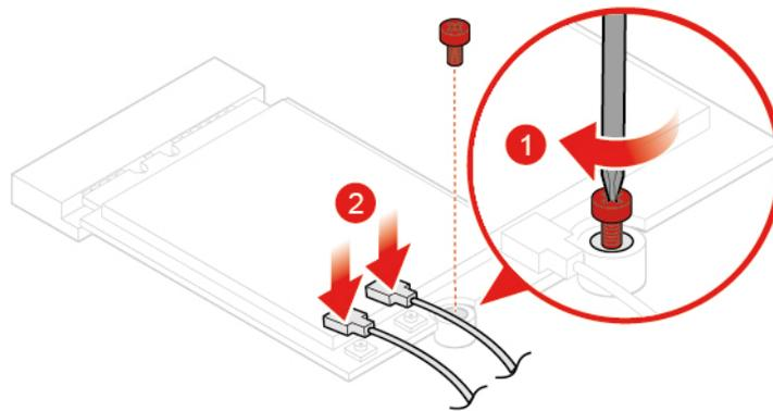
Abbildung 64. Wi-Fi-Antennen anschließen
