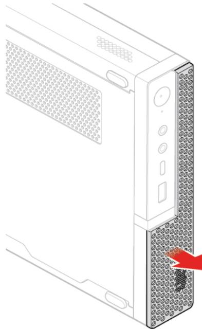
Abbildung 30. Staubschutzabdeckung entfernen
