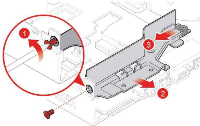
Abbildung 82. Antennenhalterung entfernen
