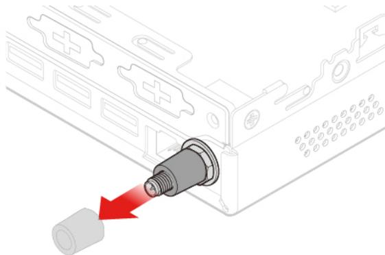
Abbildung 77. Abdeckung der Antenne entfernen, die das hintere Wi-Fi-Antennenkabel sichert
