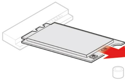
Abbildung 68. Wi-Fi-Karte entfernen
