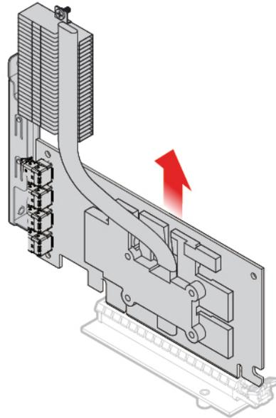
Abbildung 39. PCI-Express-Kartenadapter entfernen
