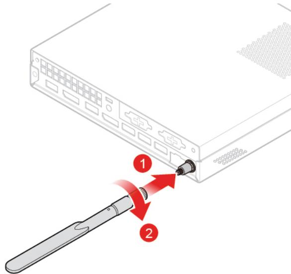
Abbildung 81. Hintere Wi-Fi-Antenne anbringen
