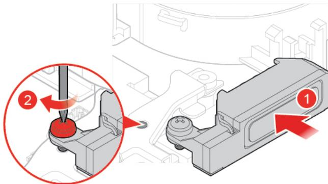
Abbildung 45. Erweiterten Lautsprecher installieren
