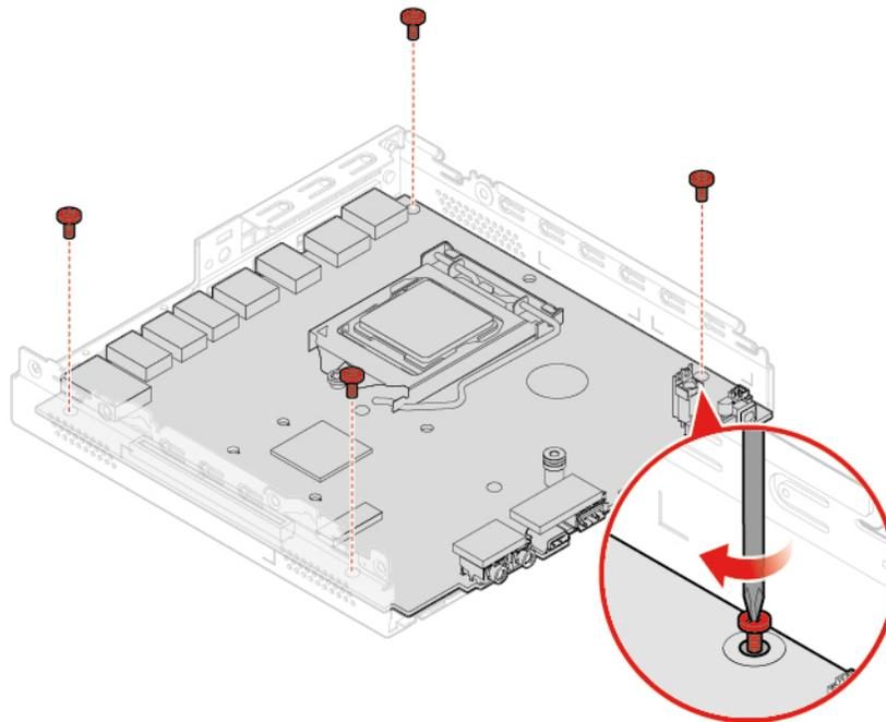
Abbildung 97. Schrauben zum Befestigen der Systemplatine anbringen
