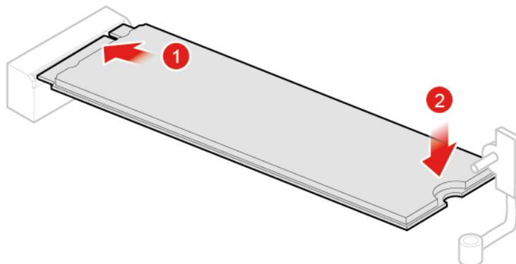
Abbildung 92. M.2-Solid-State-Laufwerk installieren
