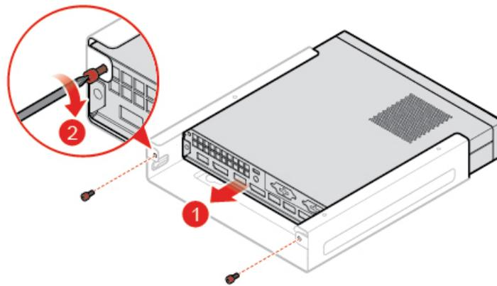
Abbildung 23. VESA-Halterung installieren
