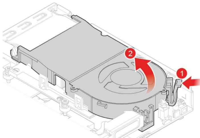
Abbildung 46. Systemlüfter entfernen
