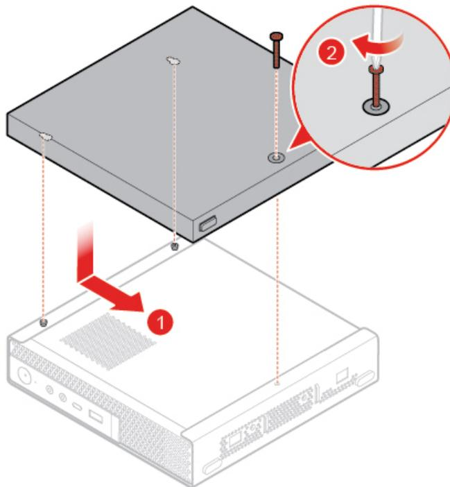
Abbildung 27. Gehäuse für das externe optische Laufwerk installieren
