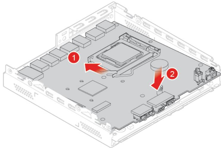
Abbildung 96. Systemplatine installieren
