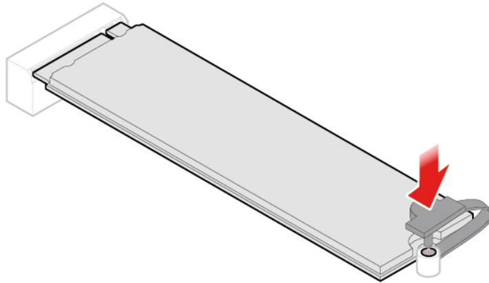
Abbildung 93. Die Klammer des M.2 Solid-State-Laufwerks verriegeln
