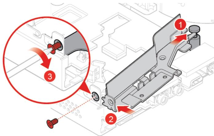
Abbildung 83. Antennenhalterung installieren
