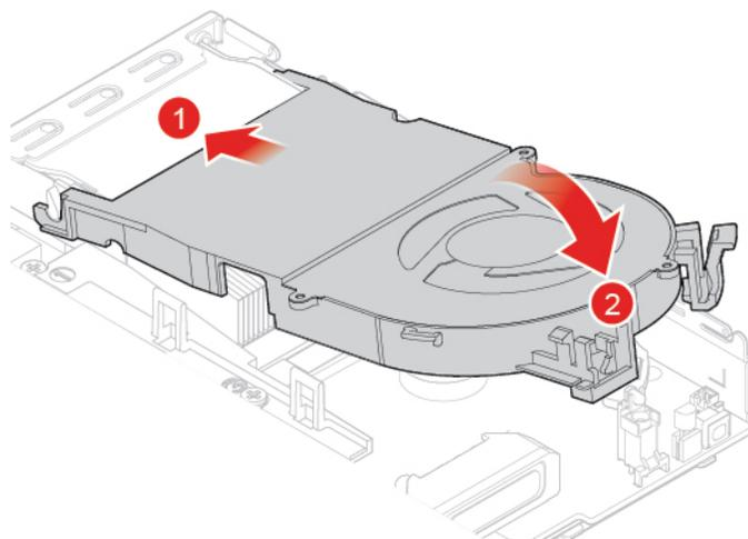
Abbildung 47. Systemlüfter installieren
