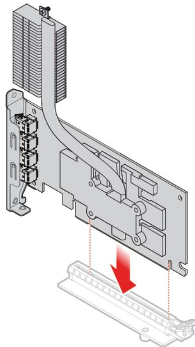
Abbildung 40. PCI-Express-Kartenadapter installieren
