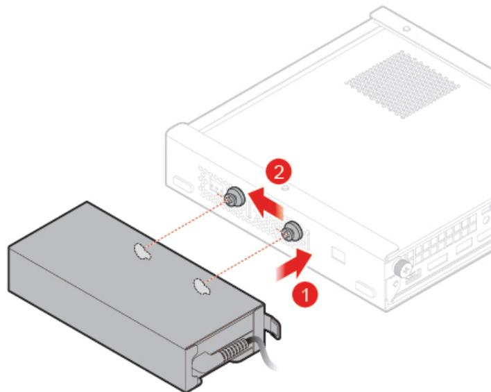
Abbildung 29. Netzteilhalterung installieren
