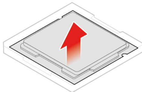
Abbildung 56. Mikroprozessor entfernen
