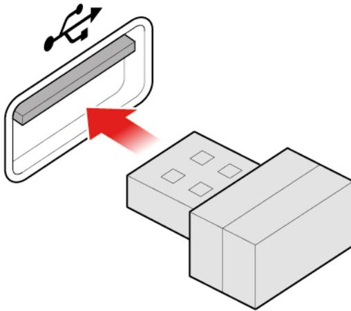
Abbildung 12. Anschließen des USB-Dongles an einen USB-Anschluss
