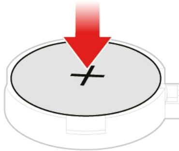
Abbildung 53. Knopfzellenbatterie nach unten drücken
