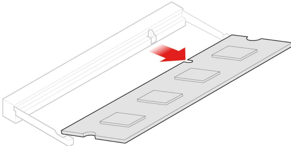
Abbildung 87. Speichermodul entfernen
