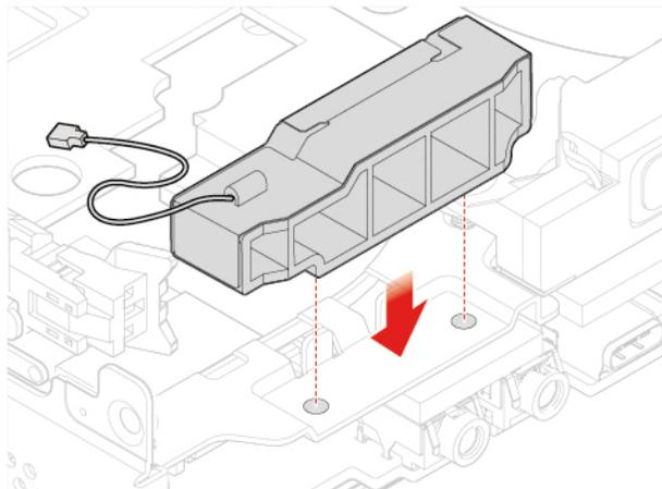
Abbildung 74. Vordere Wi-Fi-Antenne anbringen
