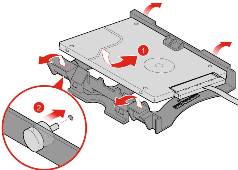
Abbildung 34. Speicherlaufwerk installieren
