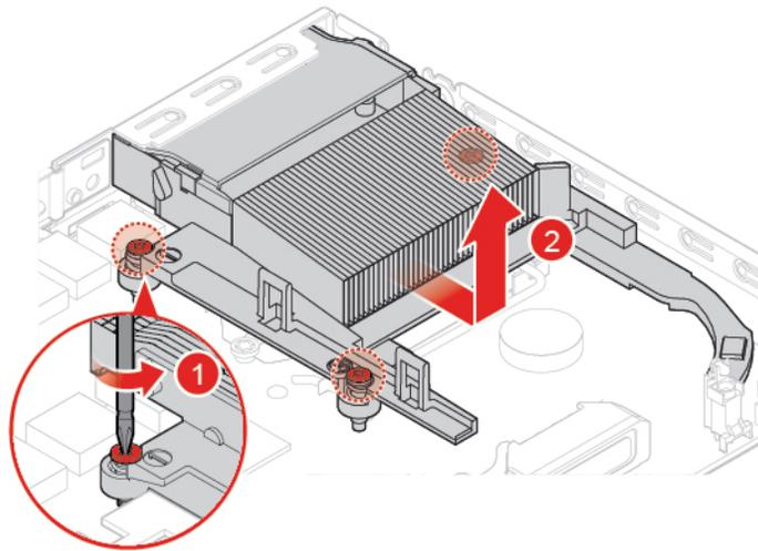
Abbildung 48. Kühlkörper entfernen
