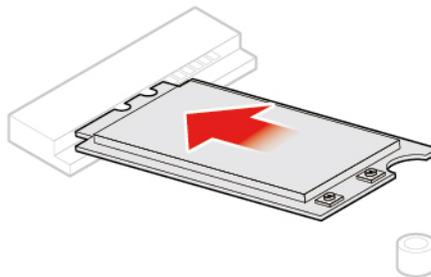
Abbildung 69. Wi-Fi-Karte installieren
