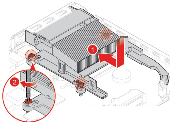
Abbildung 49. Kühlkörper installieren
