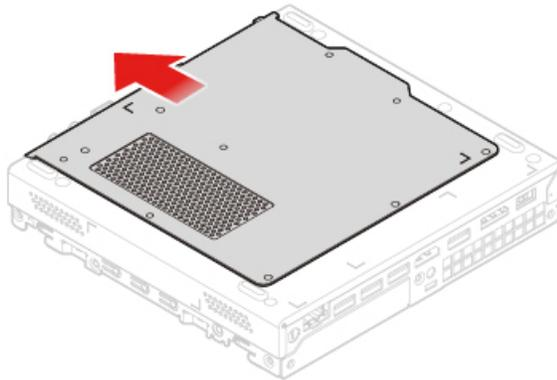
Abbildung 84. Untere Abdeckung entfernen
