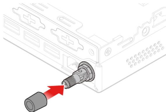
Abbildung 80. Abdeckung der Antenne anbringen, die das hintere Wi-Fi-Antennenkabel sichert
