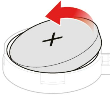
Abbildung 51. Knopfzellenbatterie entfernen
